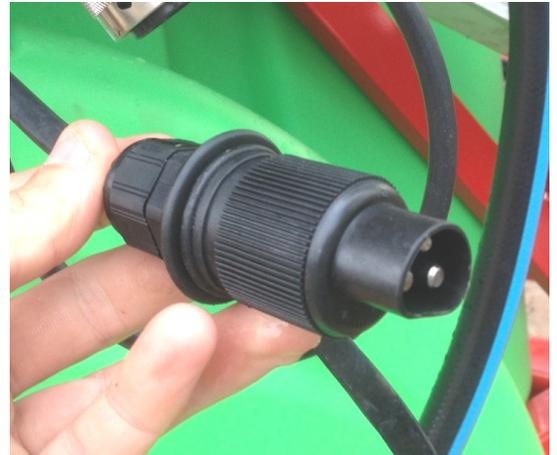
Conexión de control de secciones de pulverización
