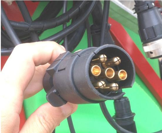
Conexión dispositivos alumbrado
