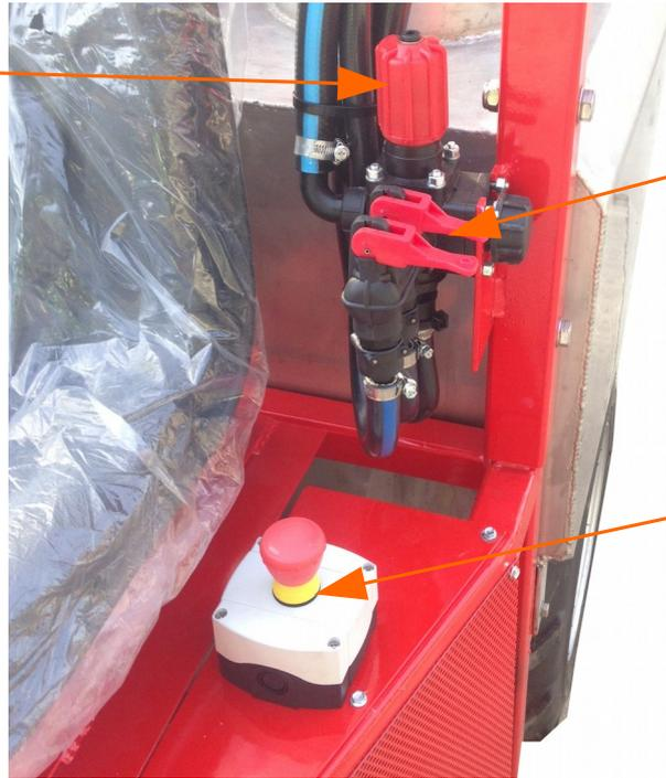
Válvulas de sección de pulverización (Izquierda / derecha) cerradas
