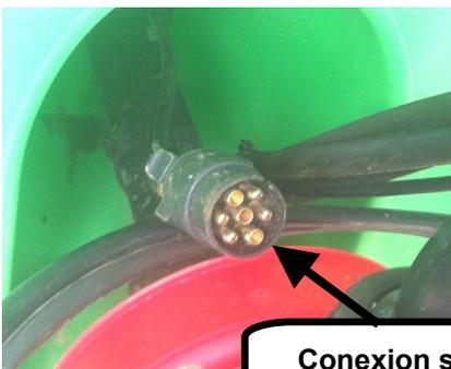
**Conexion sistema de alumbrado**
